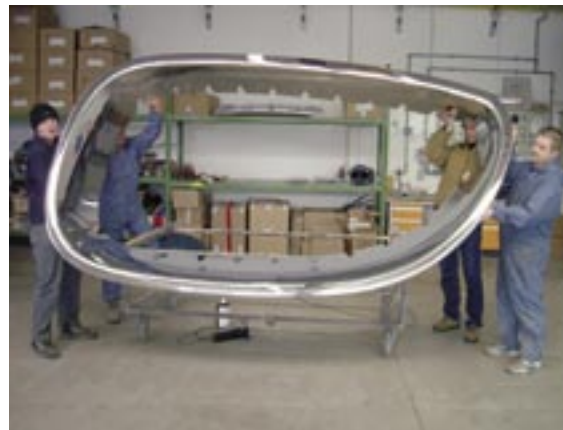
Die »verchromten« Teile mussten in einem aufwändigen Lackspiegel-Verfahren veredelt werden, um »beinahe echten« Glanz zu erzeugen.
