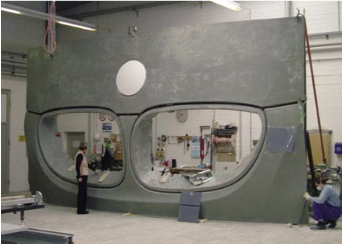
Die Nierenkonstruktion wurde aus brandschutz-zertifizierter Glasfaser gebaut und mit original BMW-Lackierung versehen.
